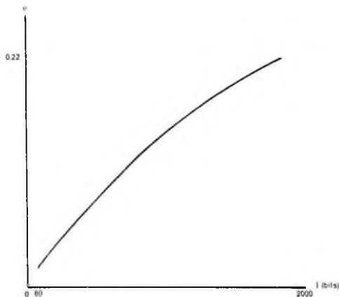
Figura 4.5 Aprovechamiento de la red contra longitud de mensaje (experimental por sondeo)
