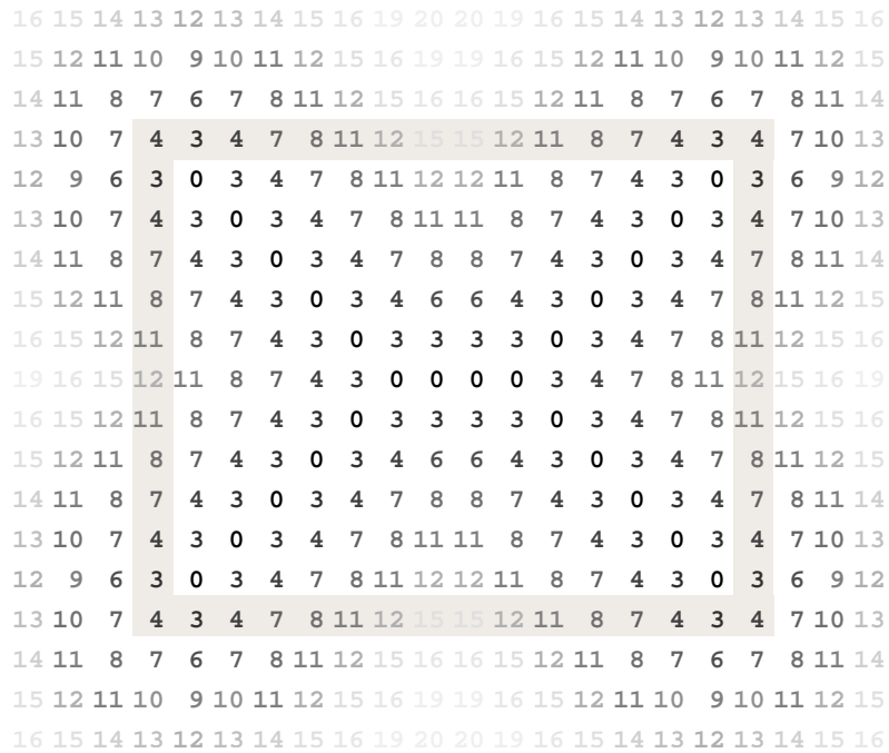
Figura 3.12: Mapa de distancias numérico del eje medio del rectángulo de la figura 3.11. La región resaltada representa la región de los pixeles que conforman el rectángulo.
