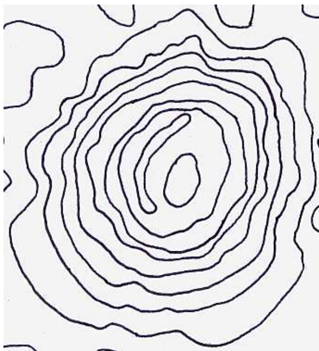
Figura 1.1: Imagen digitalizada del dibujo de las líneas de contorno de un cerro tomado del mapa topográfico E14B47 del INEGI.
