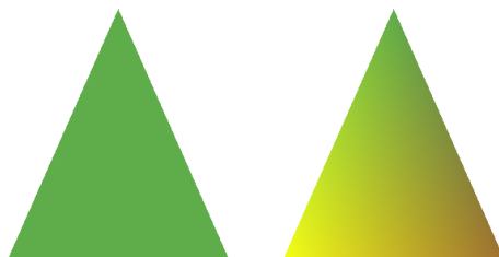
Figura 5.4: Ejemplos de triángulos realizados con OpenGL. El triángulo de la izquierda ha sido coloreado con un sólo color (coloreado liso) y el de la derecha con tres colores diferentes (coloreado degradado).
