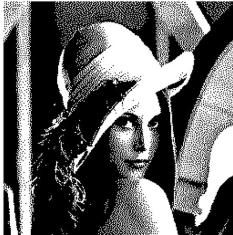
Figura 5.23: Imagen recuperada sin considerar un valor de umbral, a un primer nivel de descomposición *wavelet*, con 1 bpp. basada en la transformada Coiflets C-6.
