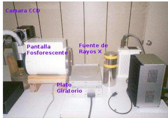
Figura 2.1: Fotografía del tomógrafo de rayos X que existe en el Departamento de Física del Cinvestav.
