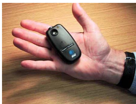
Figura A.2: Identificador usado en el sistema BAT para la ubicación de personas y dispositivos
