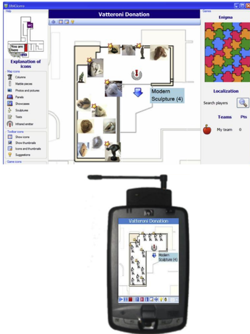
Figura 2.5: UbiCicero, una guía de museo sensible a la ubicación del usuario: el sistema se ha montado en una PDA equipada con un lector RFID
