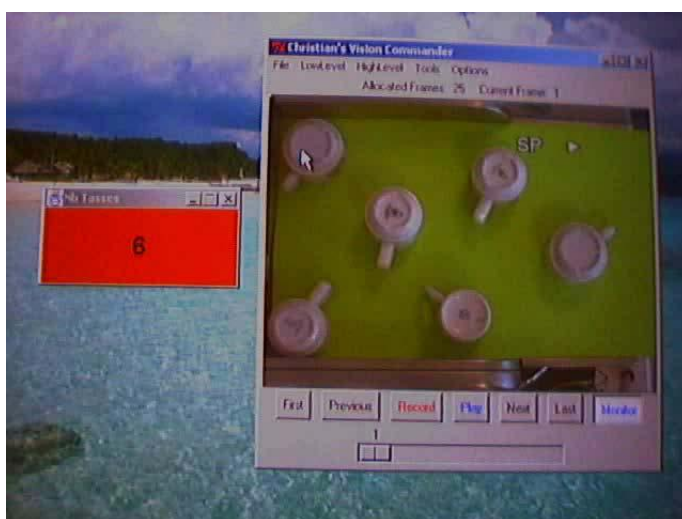
Figura 3.6: Sistema contextual que envía correos electrónicos con base en el número de tazas disponibles
