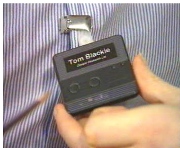
Figura A.1: Tarjeta usada en el sistema Active Badge para la ubicación de personas
