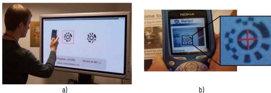
Figura 2.7: Mediante un teléfono celular se toma una fotografía de una etiqueta visual. Al identificar la etiqueta, el sistema regresa información relevante al teléfono móvil: a) la etiqueta visual se encuentra en un despliegue público, b) la etiqueta visual se encuentra en una superficie de papel.
