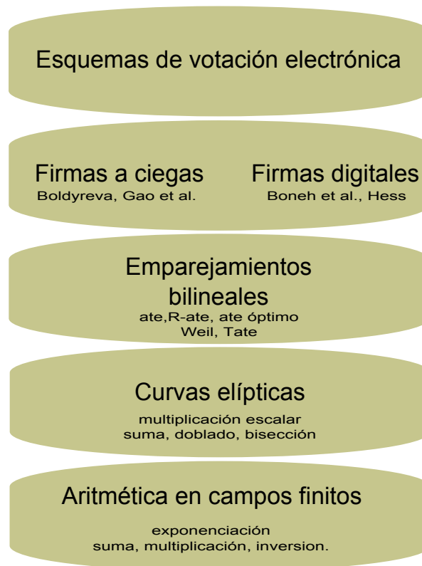
Figura 1.1: Modelo de capas de un esquema de votación electrónica
