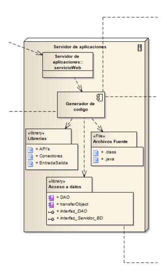
Figura 5.36: C) Vista Física de la aplicación Web
