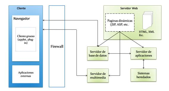
Figura 3.3: Vista física de una aplicación Web
