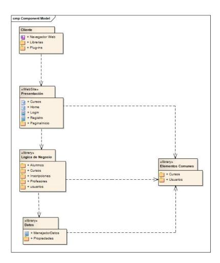
Figura 5.19: Distribución de los componentes entre las capas
