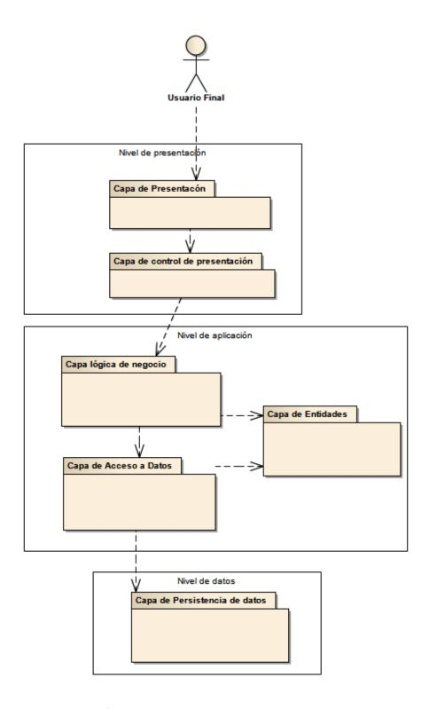
Figura 4.4: Arquitectura dividida en tres niveles y seis capas
