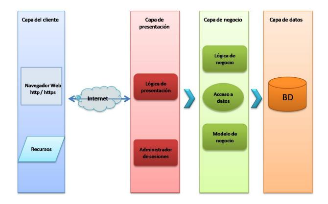
Figura 5.17: Arquitectura de N capas para una aplicación Web
