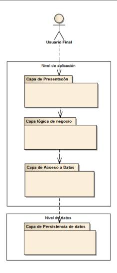
Figura 4.2: Arquitectura dividida en dos niveles y cuatro capas
