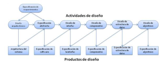
Figura 2.2: Modelo general del proceso de diseño
