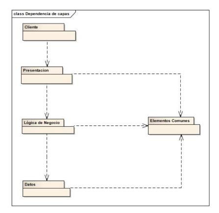
Figura 5.18: Dependencias entre las capas de la arquitectura de N capas
