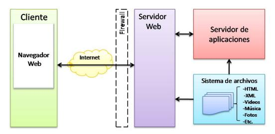
Figura 4.8: Arquitectura para aplicaciones Web dinámicas
