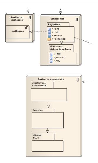
Figura 5.35: B) Vista Física de la aplicación Web
