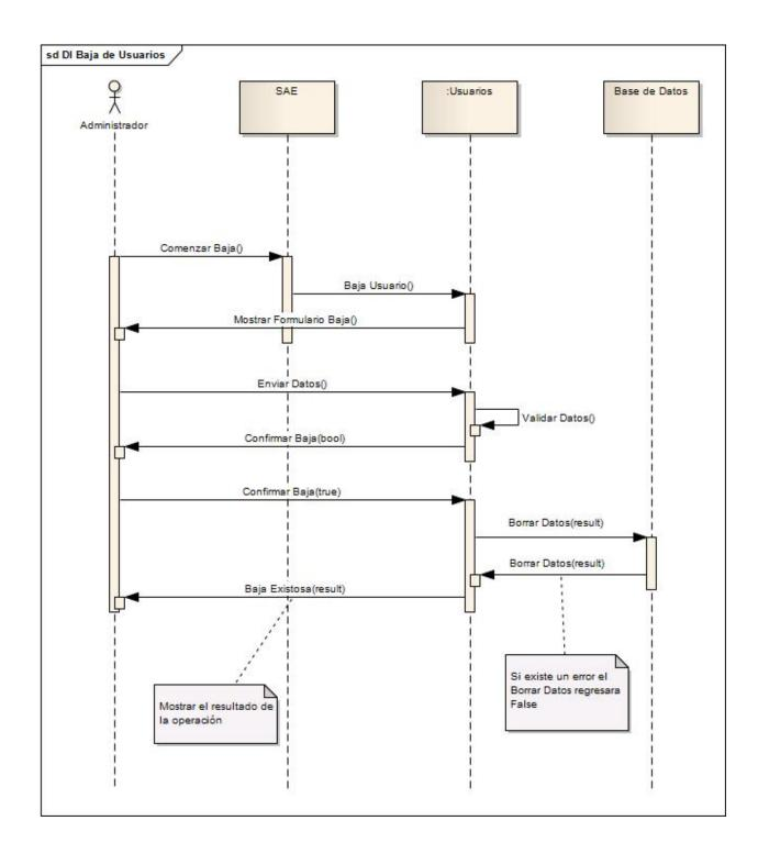
Figura 5.4: Diagrama de secuencia del caso de uso Baja de usuario
