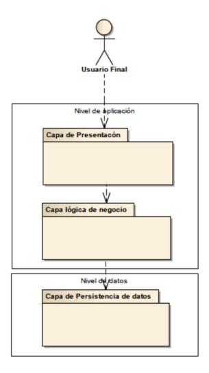
Figura 4.1: Arquitectura dividida en dos niveles y tres capas
