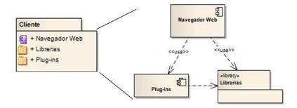
Figura 5.20: Componentes de la capa del cliente
