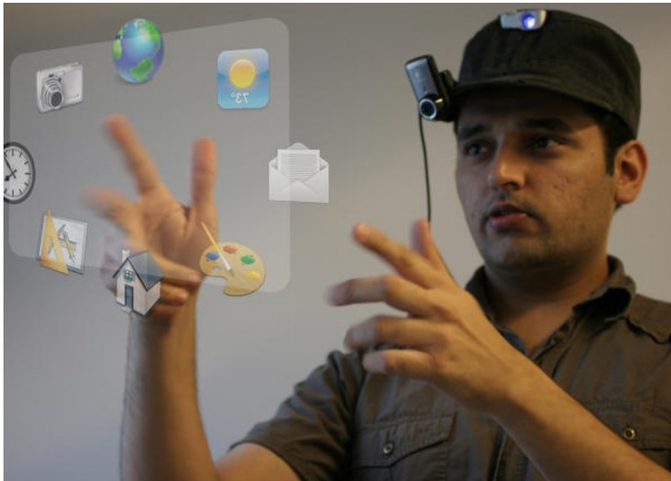
Figura 2.10: WUW se compone de un pico-proyector, una cámara y una unidad de procesamiento, podemos ver la interacción con las proyecciones.
