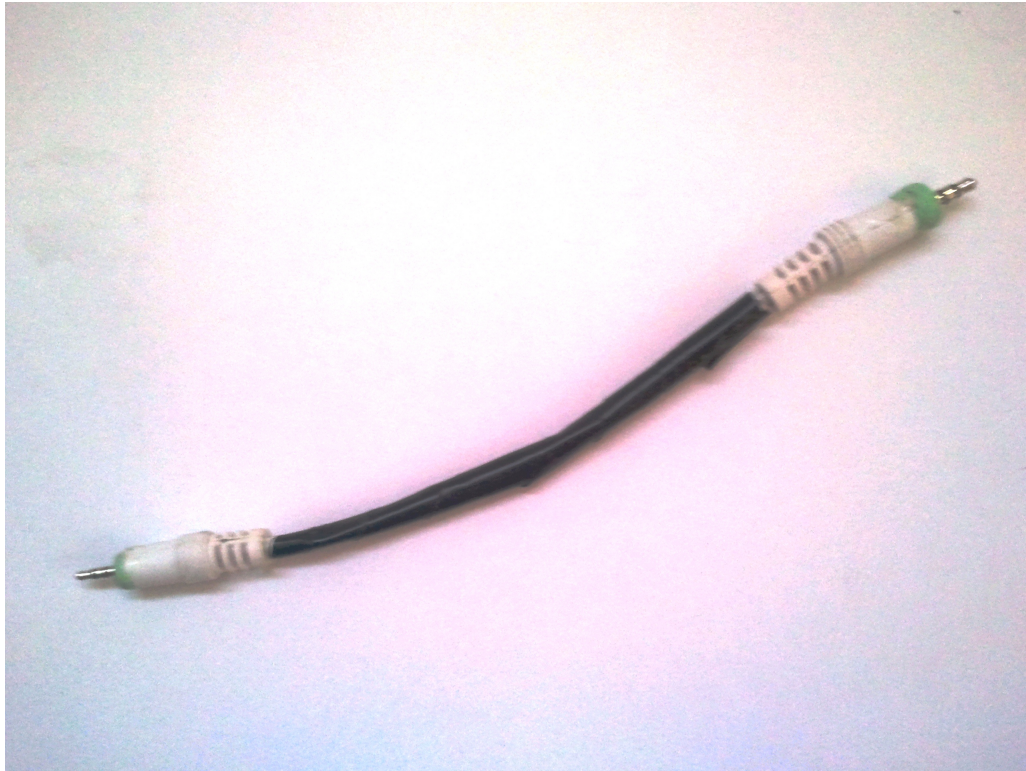
Figura 4.4: Cable construido para la conexión entre el pico-proyector y el telefono celular
