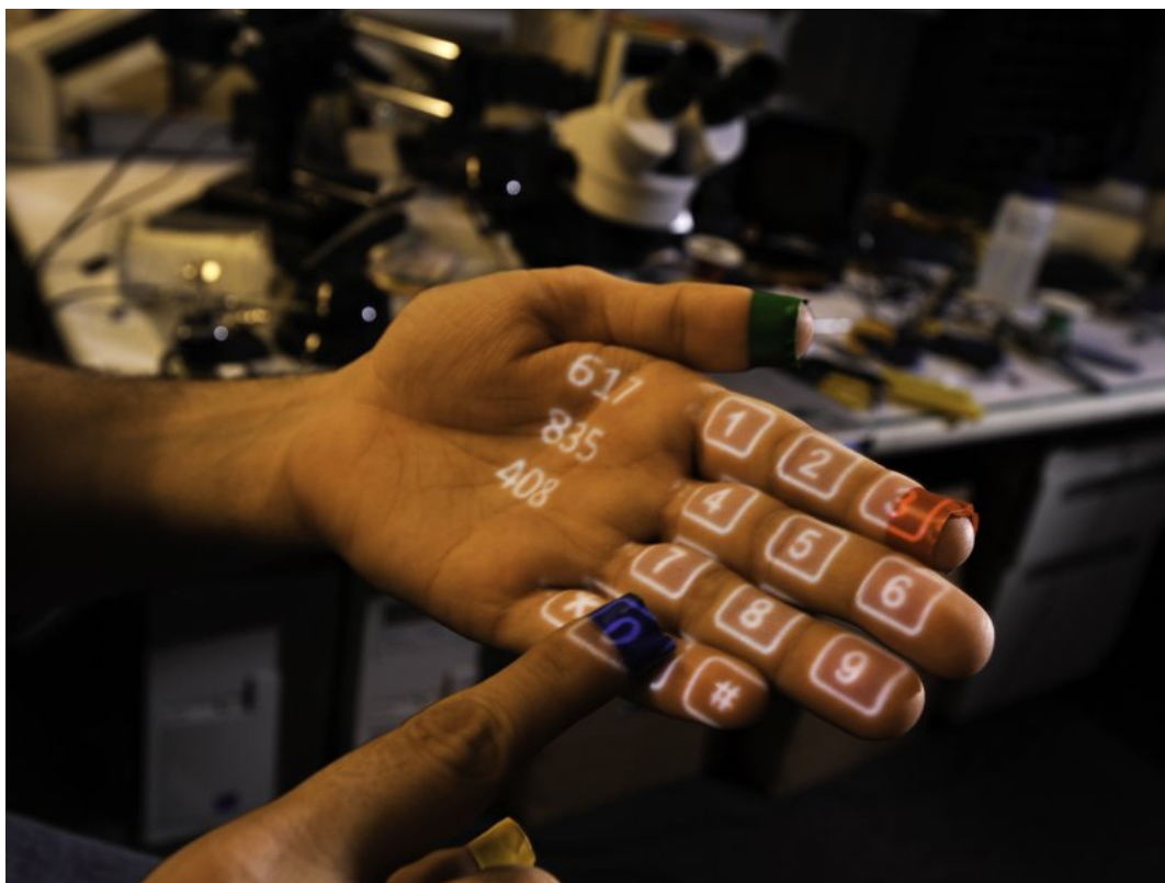
Figura 2.4: Sexto Sentido nos permite tener una calculadora en la mano en cualquier momento y cualquier lugar que se usa tal cual una calculadora real.
