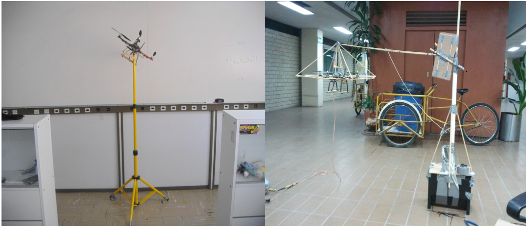
Figura 5.12: Estructuras para las pruebas de evolución diferencial de postura y altura del cuadricóptero.
