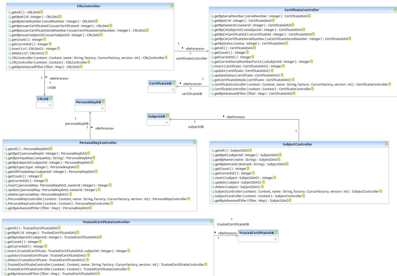
Figura 4.17: Diagrama de clases - controller.
