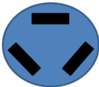
Figura 2.8: Arreglo de ruedas omnidireccional
