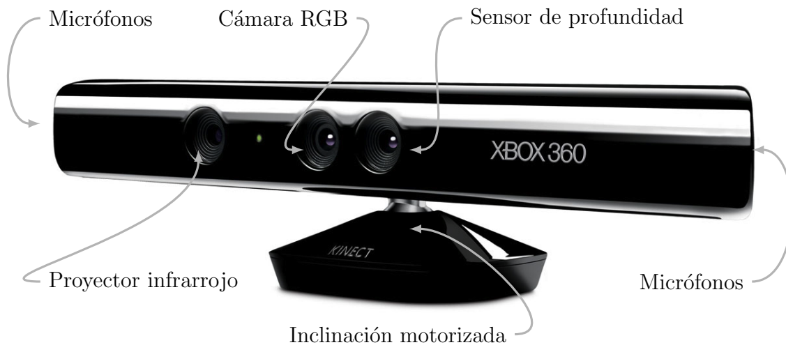
Figura 3.9: Componentes de Kinect.
