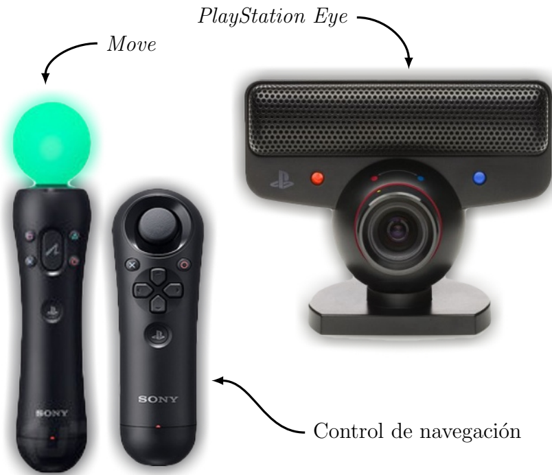
Figura 3.8: Componentes del sistema PlayStation Move
