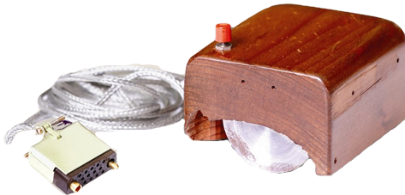
Figura 1.1: Primer prototipo de ratón para computadora desarrollado por Douglas Engelbart.
