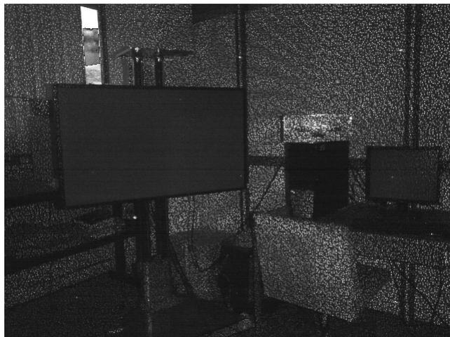
Figura 3.6: Imagen del patrón de puntos infrarrojos del área de trabajo del autor capturada con Kinect
