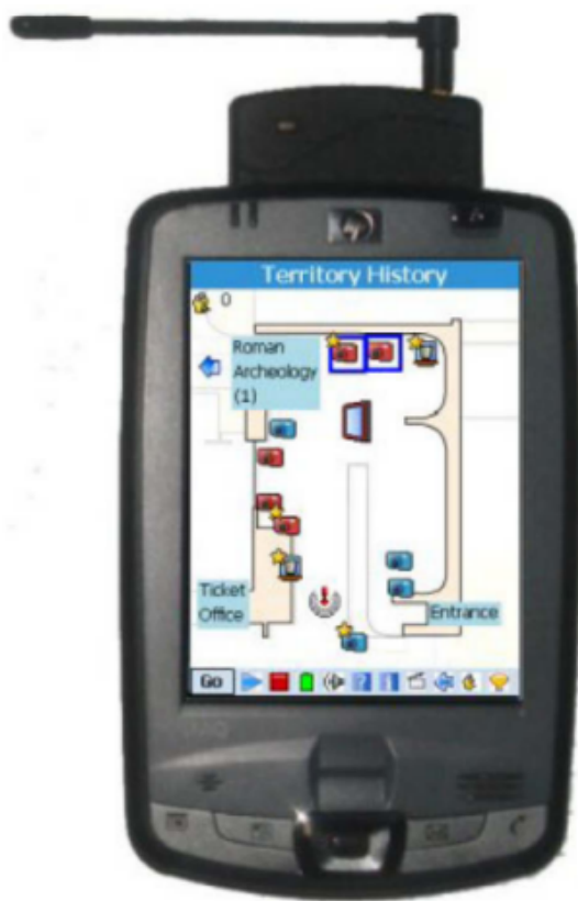
Figura 2.5: UbiCicero en un PDA con un lector RFID
