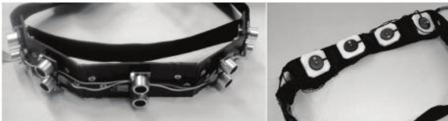
Figura 3.3: Cinturón con sensores ultrasónicos
