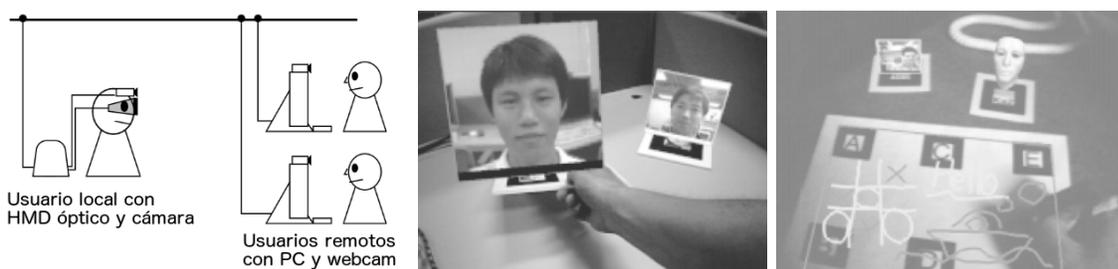
Figura 3.4: Sistema de videoconferencia con realidad aumentada, utilizando *Open Shared Space*. Esquema de comunicación entre un usuario local y dos remotos (izquierda). La vista de usuario local a través de un HMD óptico (centro), donde puede ver en video a los colaboradores remotos, aumentados sobre los marcadores. Un pizarrón compartido en realidad aumentada (derecha).
