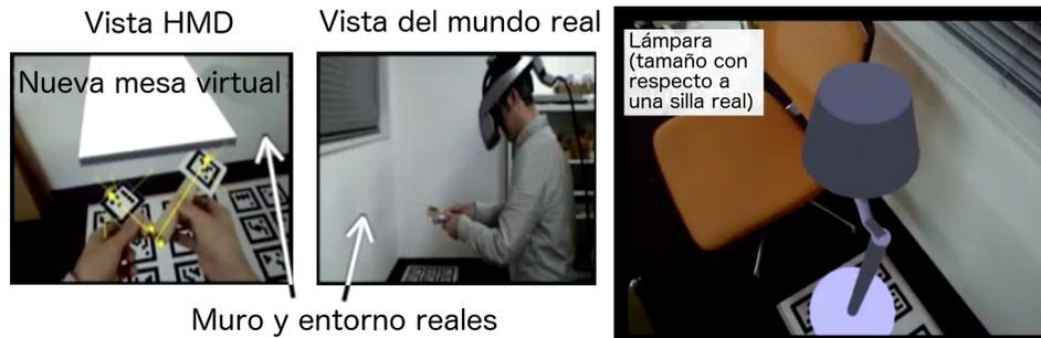
Figura 3.13: En *Situated Modeling* el usuario lleva puesto un HMD con una cámara Web y puede observar el entorno y las primitivas reales (izquierda). Los objetos virtuales agregados forman muebles que se pueden visualizar alineados en el entorno real y con el tamaño que tendrá el mueble en la realidad (derecha).
