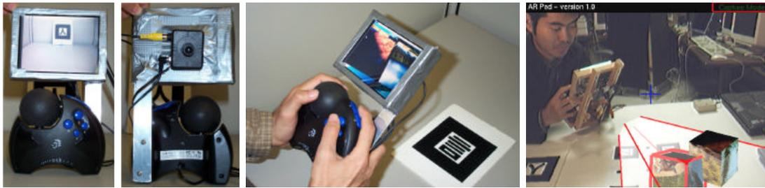
Figura 3.6: El dispositivo *AR Pad* consta de un control compacto con *trackball*, botones, una pantalla LCD y una cámara Web (izquierda). *AR Pad* apuntando hacia un marcador de *ARToolKit* (centro). Un colaborador observa la escena real junto con un par de modelos virtuales aumentados y el colaborador con su *AR Pad* (derecha), se muestra también el frustum y el objeto seleccionado por él, en líneas rojas.
