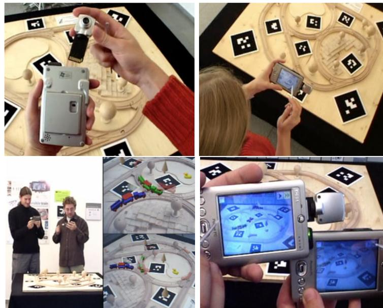
Figura 3.7: En *Invisible Train* se utiliza una PDA con cámara (arriba izquierda). Se apunta la cámara hacia las vías de madera con marcadores de *ARToolKit* (arriba derecha). Dos usuarios (abajo izquierda) colaboran o compiten al hacer cambios de vía, usando sus stylus. La vista de dos PDAs (abajo derecha) es sincronizada via WiFi.
