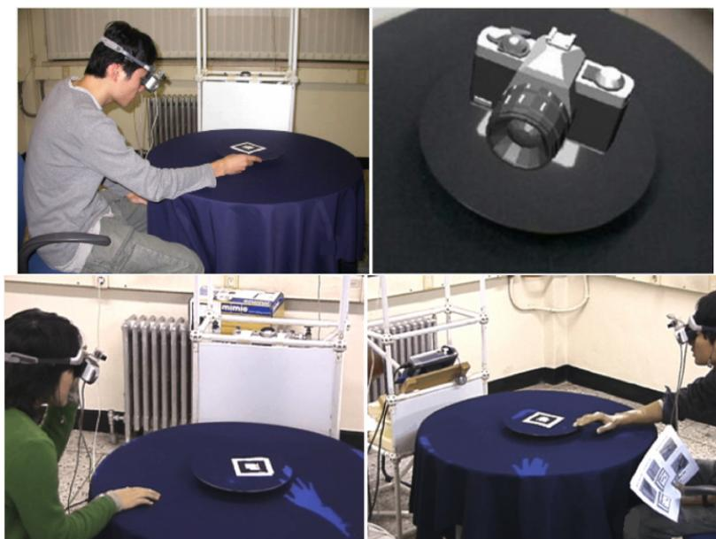
Figura 3.11: Un colaborador examina el modelo virtual de un producto en la mesa giratoria (superior izquierda). El producto que observa es una cámara (superior derecha). Cuando dos colaboradores examinan el producto pueden girar las mesas de manera sincronizada para enfocar la discusión. Dos colaboradores pueden señalar en algún punto de la mesa mediante la sombra virtual de su brazo, proyectado en la mesa del otro colaborador (inferiores).
