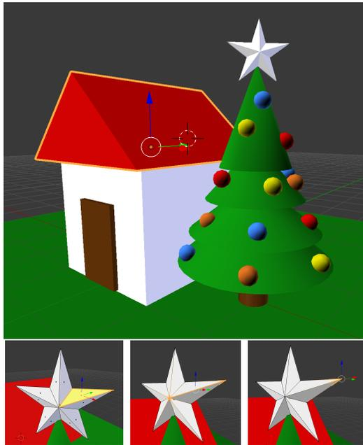
Figura 2.3: Modelos 3D construídos a partir de mallas poligonales. La casa y el árbol están formados por figuras geométricas (arriba). La estrella consta de un conjunto de caras triangulares, de las cuales una está seleccionada (abajo izquierda). Se muestran seleccionados los componentes de la cara: una arista (abajo centro) y un vértice (abajo izquierda).
