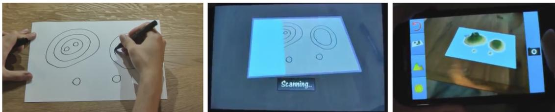
Figura 3.18: Uso de la aplicación *LandscapeAR*: el usuario dibuja varias curvas de nivel (izquierda), luego captura el dibujo a través de la aplicación (centro), la cual genera el mapa de elevación y visualiza la superficie, aumentada sobre el dibujo (derecha).
