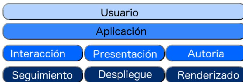
Figura 2.8: Componentes de un sistema de realidad aumentada [17].
