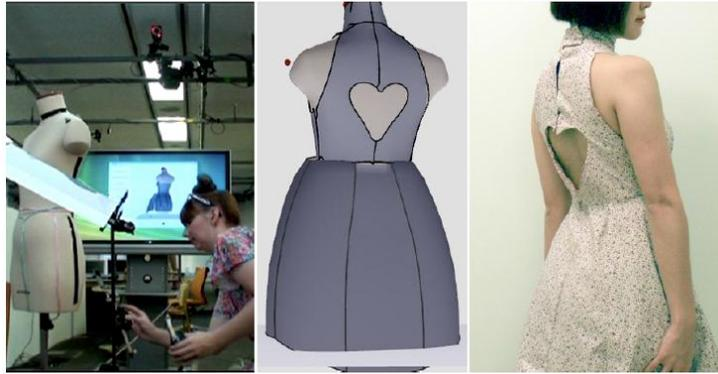
Figura 3.15: *DressUp*: el usuario utiliza dos herramientas tangibles con marcadores para crear la forma de un vestido sobre un maniquí real (izquierda), el modelo virtual del vestido aumentado sobre el maniquí (centro) y el vestido real fabricado a partir del diseño virtual (derecha).
