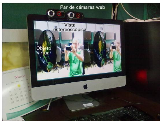
Figura 10.2: Montaje de hardware para la captura de video estereoscópico en un sistema de escritorio. Se muestra el video aumentado con un objeto virtual, mostrado también en estéreo.
