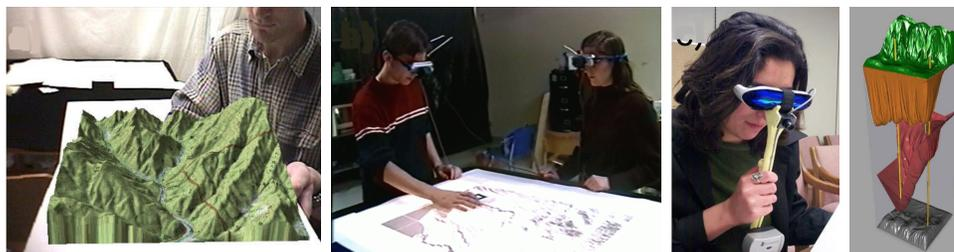
Figura 3.8: Modelo geológico visualizado en realidad aumentada (primera, de izquierda a derecha), dos colaboradores utilizando *ARprism* (segunda), visor *Sony Glasstron* colocado en una montura (tercera) y modelo de un terreno con estructura subterránea (cuarta).
