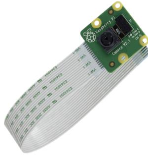
Figura 3.3: Modulo cámara Raspberry Pi.
