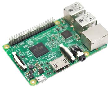
Figura 3.2: Raspberry Pi 3 modelo B.
