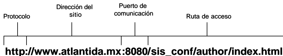
Figura 8-1 Estructura de un URL
