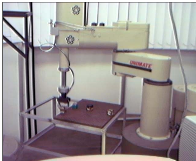
Figura 2.1. Aspecto del robot industrial UNIMATE S-103
