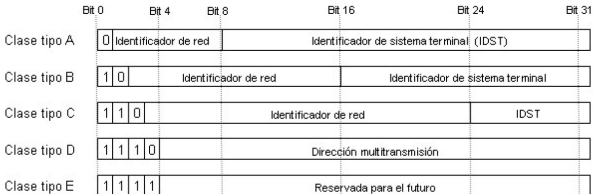
Figura 2.3: Clases de direcciones de IPv4, que describen un comportamiento jerárquico.
