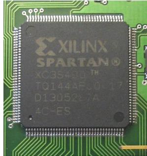
Figura 2.1: Encapsulado de un FPGA Xilinx [42]
