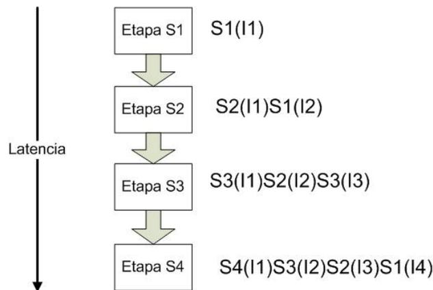
Figura 2.7: Ejemplo de la técnica de tubería o pipe-line
