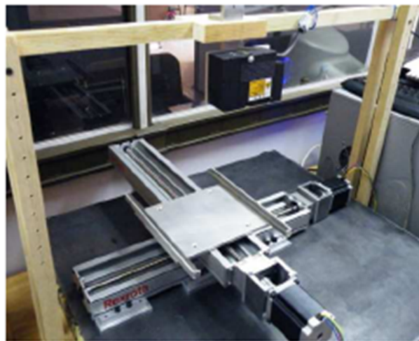
Figura 2.11: Configuración final del diseño físico del escáner 3D
